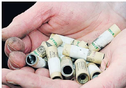
Ganz schön abgebrannt: Für ihren ersten Flugversuch nutzten die EGW-Schüler mit den 1/2 A 3-Treibern die kleinstmöglichen Zünder.
